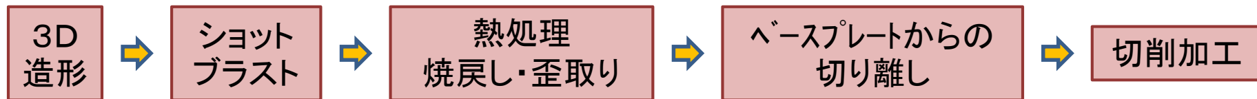
図11. HTC™を用いた金型の製造工程(想定)
