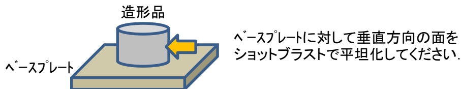
図13. ショットブラストによる造形品表面変化例
