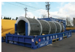
列車・トレーラー共に積載可能な鋼材専用無蓋コンテナ
