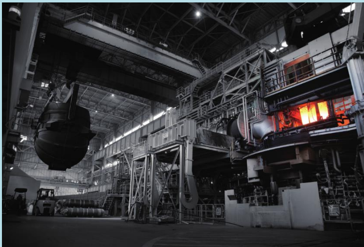
当社知多工場稼働する炉体回転式電気炉 (STARQ®)
